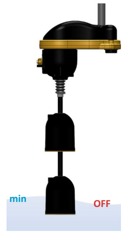
Il livello min. arresta la pompa
